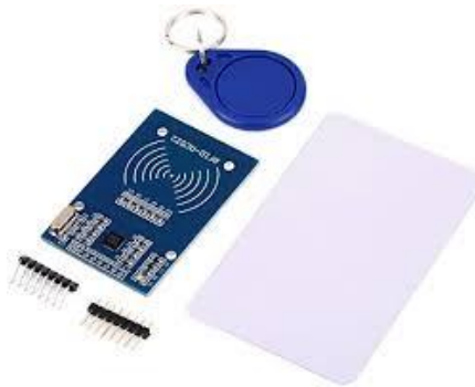
Gambar 1 Modul RFID MFRC522, Tag, dan Reader
